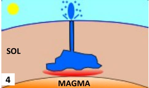
A- Le magma réchauffe le réservoir. La pression augmente : cela forme une bulle de vapeur.
