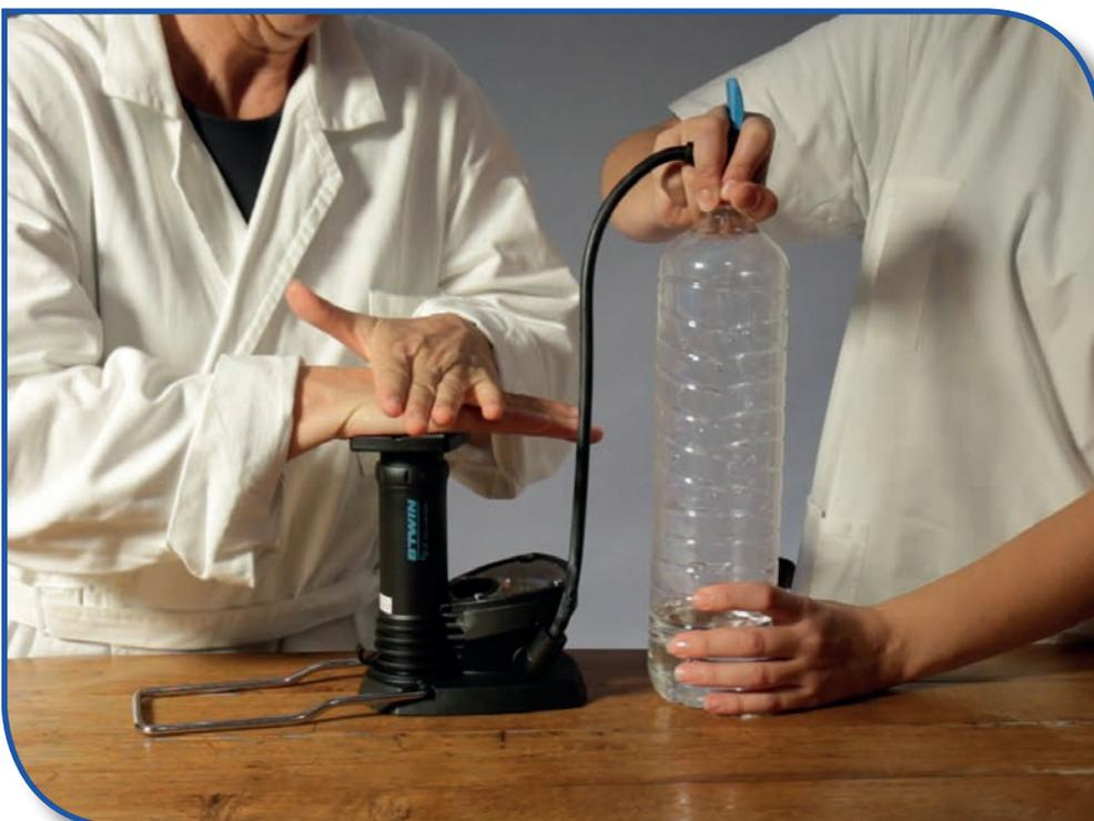
**Une animation permet de comprendre que la vapeur d'eau se condense au contact de l'air froid.**
